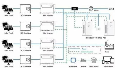
El sistema de almacenamiento de energía comercial e industrial DEMUDA, todo en uno, de 50 kW/100 kWh para montaje en rack, integra inversores, paquetes de baterías, un sistema de ...
