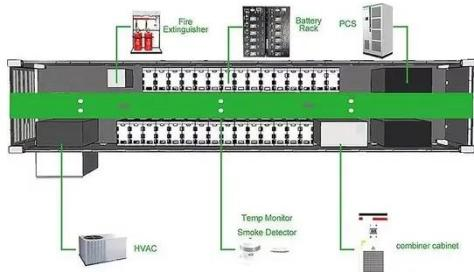
5 de jun. de 2024 · El gabinete de almacenamiento de energía de la estación base está diseñado para albergar componentes críticos que aseguran la eficiencia energética y la operatividad ...
