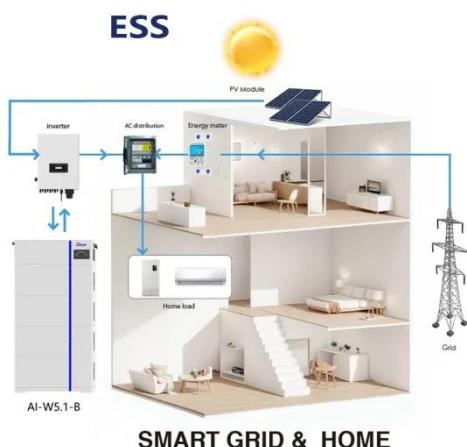
principal del sistema de generación de energía solar, el inversor solar es el dispositivo clave para convertir la corriente continua en corriente alterna.
